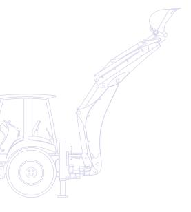
ENGINE POWER 74 kW / 99,2 HP @ 2.200 rpm OPERATING WEIGHT 7.460 kg
