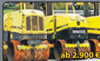
Grabenwalze Wacker RT82SC | Gewicht: 1.473 kg | Zentrifugalkraft: 68,4 kN |
