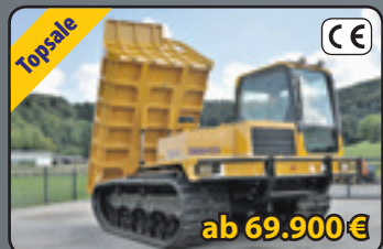
Raupendumper Dash-8 | auf Gummiketten | Zuladung bis 12.000 kg |
